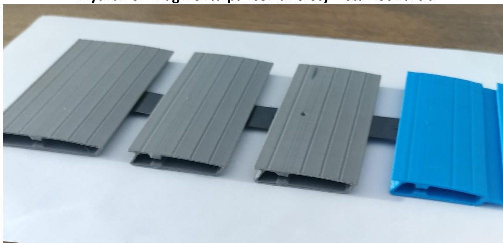
Wydruk 3D fragmentu pancerza rolety – stan otwarcia
